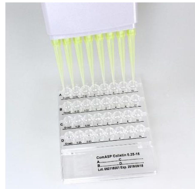
Slika 1. ComASP™ Colistin bujon mikrodilucioni test
